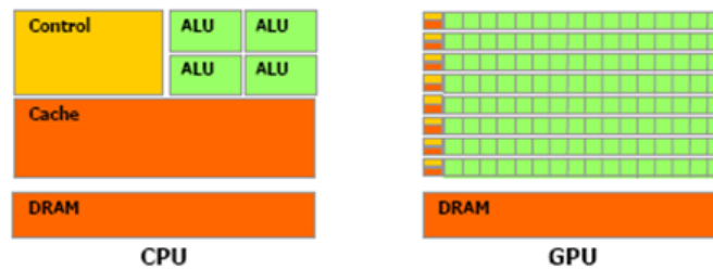
Obr. 1.1: Porovnání stavby CPU a GPU, [1].
